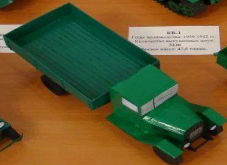
Зис-5 Годы производства: 1933-1958 гг. Грузоподъемность: 3 тонны. Объем двигателя: 5550 см 3 . Мощность: 73 л.с.
